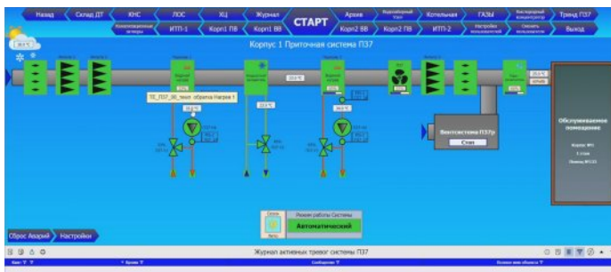
Окно состояние приточек где отображаются текущие состояния и показания основных датчиков, влияющих на работу системы.
