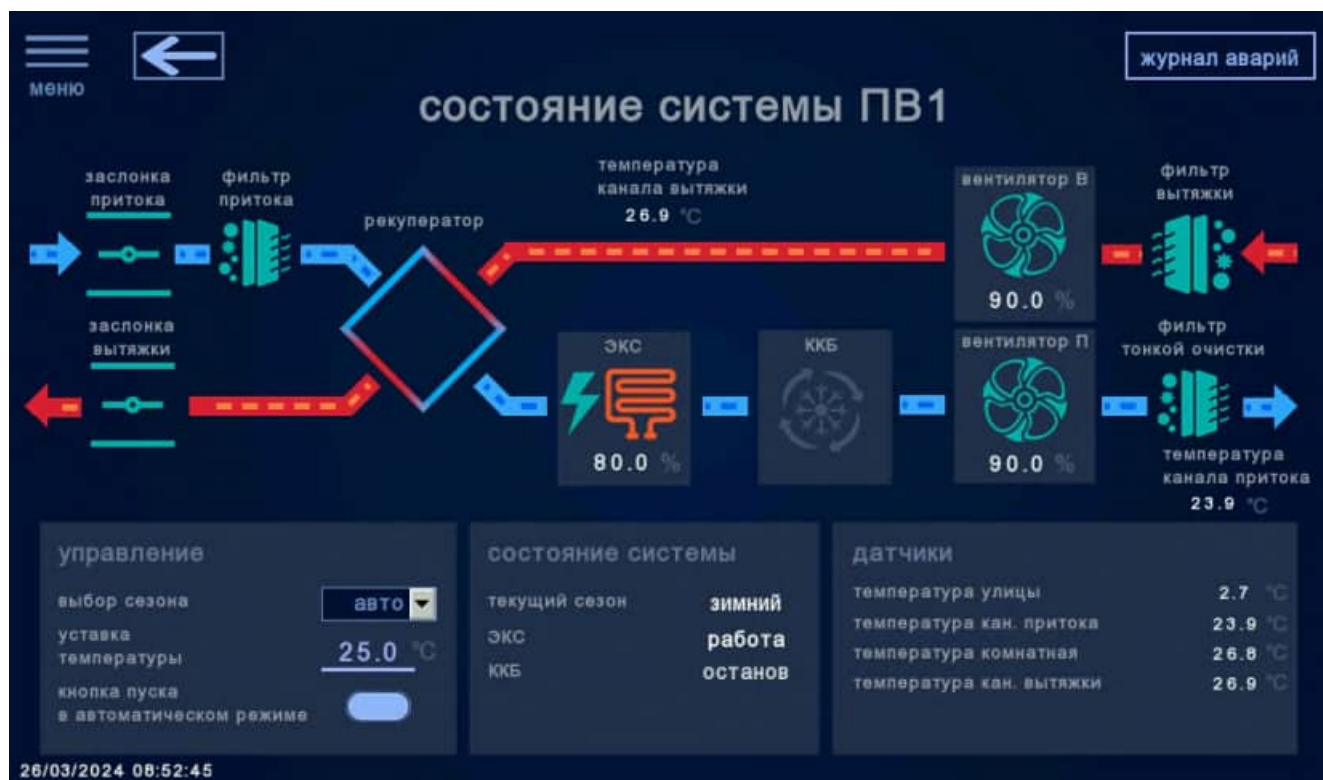
Рисунок 5 – Меню «состояние системы» для системы ПВ1
