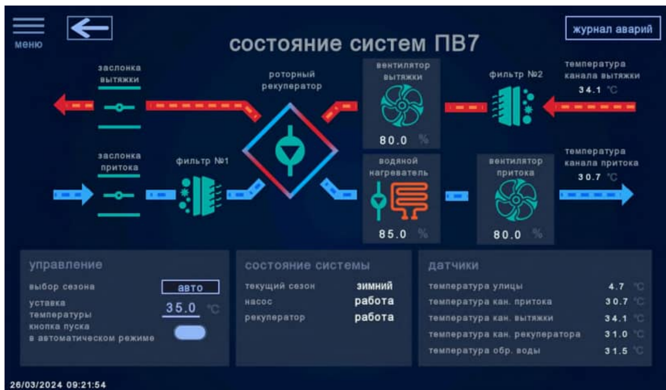
Рисунок 6 – Меню «состояние системы» для системы ПВ7
